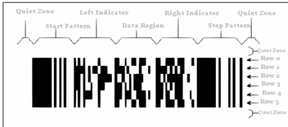
รูปที่ 4 แสดงส่วนประกอบของบาร์โค้ด 2 มิติแบบ PDF417
